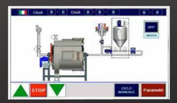
VISTA DEL TOUCH SCREEN DEL BOTTALE CON ACCESSO ALLE OPZIONI ACQUAMIXER VIEW OF THE DRUM TOUCH SCREEN WITH ACCESS TO THE AC-QUAMIXER OPTIONS
