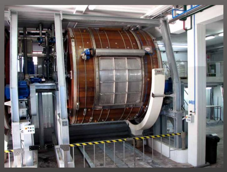
VISTA DI BOTTALE IN LEGNO CON PORTA AUTOMATICA A MOVIMENTAZIONE PNEUMATICA VIEW OF WOODEN DRUM WITH AUTOMATIC PNEUMATIC HANDLING DOOR
